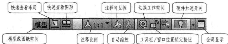
图 10-5 屏幕图形观察及操作按钮的功能
