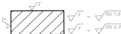
图 8-21 用带字母的符号以等式形式的表面结构简化注法
