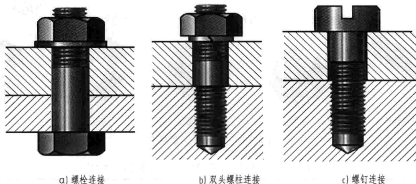
图 7-13 螺纹紧固件的连接形式
